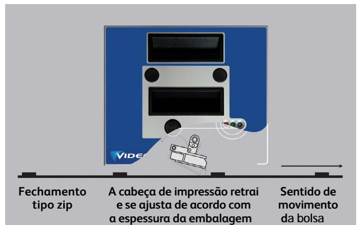
**Uma simples configuração do software pode retraindo o cabeçote de impressão de transferência térmica em até 4,5 mm**
